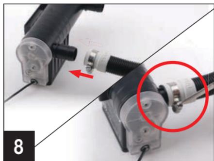
8. Schieben Sie die Metallschelle über das Ende des Filterauslassschlauchs (ca. 1 cm vom Ende entfernt) und verbinden Sie den Schlauch mit dem UVC-Verbinder, der dem Netzkabel am nächsten liegt. Die Schelle mit einem Schraubendreher festziehen.
