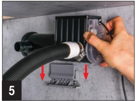
4. Schieben Sie die Metallschelle über das Ende des Filterauslassschlauchs (ca. 1 cm vom Ende entfernt) und verbinden Sie den Schlauch mit dem UVC-Verbinder (auf beiden Seiten möglich, da die UVC-Einheit in beide Richtungen funktioniert).
