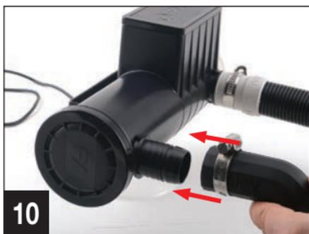
10. Verbinden Sie das lange Ende des Gummikrümmers-Adapters mit der UVC-Einheit und ziehen Sie die Schelle mit einem Schraubendreher fest.
