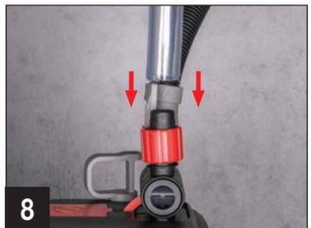
8. Befestigen Sie das andere Ende des Verbindungsschlauchs an dem Filterauslassventil. **WICHTIG:** Um eine optimale Leistung zu erzielen, stellen Sie sicher, dass alle Schläuche einen geraden Weg ohne Schlaufen und mit sehr wenig Durchhang nehmen.
