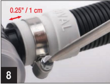
8. Überprüfen Sie, dass alle Metallschellen ca. 1 cm von den Enden entfernt sind und mit einem Schraubendreher fest angezogen wurden, damit wasserdichte Verbindungen gewährleistet sind.
