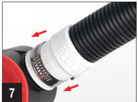
6. Schieben Sie die Metallschelle über ein Ende des 25-mm-FX-Filterauslassschlauchs für die Aquarienschrankmontage (separat erhältlich – Art.-Nr. A20233) oder eines vergleichbaren Vinylschlauchs mit einem Innendurchmesser von 25 mm (separat erhältlich). Stellen Sie sicher, dass die Schelle ca. 1 cm vom Ende des Schlauchs entfernt ist.
