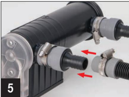
5. Schieben Sie die Metallschelle über das Ende des Filterauslassschlauchs (ca. 1 cm vom Ende entfernt) und verbinden Sie den Schlauch mit dem Schlauchadapter (auf beiden Seiten möglich, da die UVC-Einheit in beide Richtungen funktioniert).
