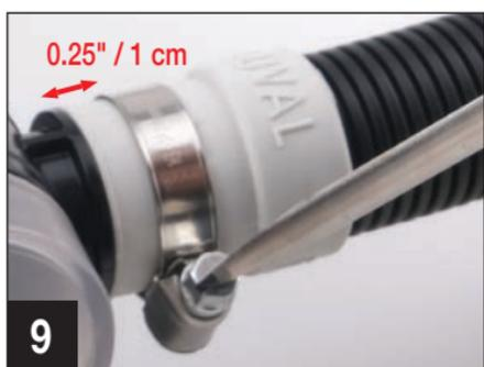
9. Überprüfen Sie, dass alle Metallschellen ca. 1 cm von den Enden entfernt sind und mit einem Schraubendreher fest angezogen wurden, damit wasserdichte Verbindungen gewährleistet sind.
