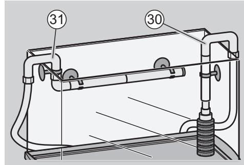
➤ Befestigen Sie das Ansaugrohr (30) wie dargestellt senkrecht an der Innenwand des Aquariums.
