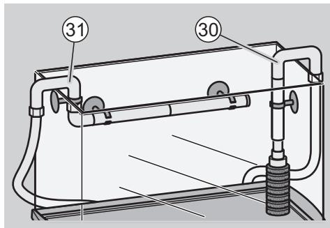
➤ Закрепите всасывающую трубку (30), как показано, вертикально на внутренней стенке аквариума.
