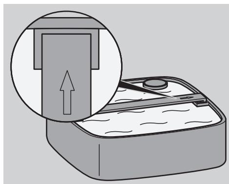
En el borde superior del depósito, en la rejilla superior y en las jaulas de los filtros hay flechas marcadas para facilitar la correcta colocación.
