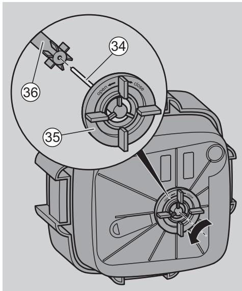
La girante è situata nella parte inferiore della testa del filtro. La girante è costituita da una ruota a palette (36) e dall'albero (34).
