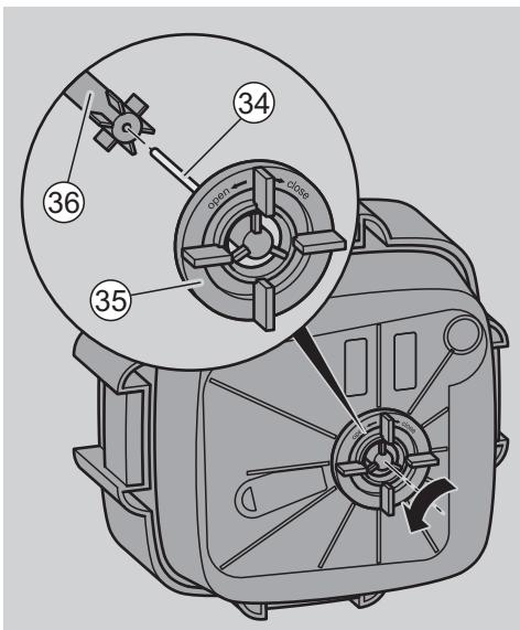
Le rotor se trouve sur la face inférieure de la tête du filtre. Le rotor se compose de la roue à ailettes (36) et de la tige du rotor (34).
