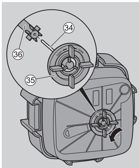
La hélice se encuentra en la parte inferior de la cabeza del filtro. Está formada por un rotor (36) y un eje propulsor (34).
