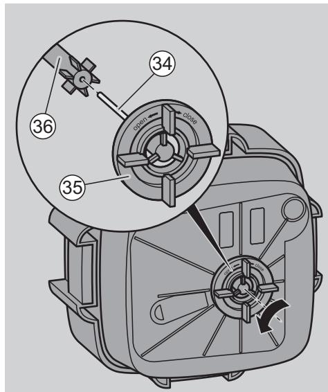
Der Impeller befindet sich auf der Unterseite des Filterkopfs. Der Impeller besteht aus Flügelrad (36) und Impellerschaft (34).
