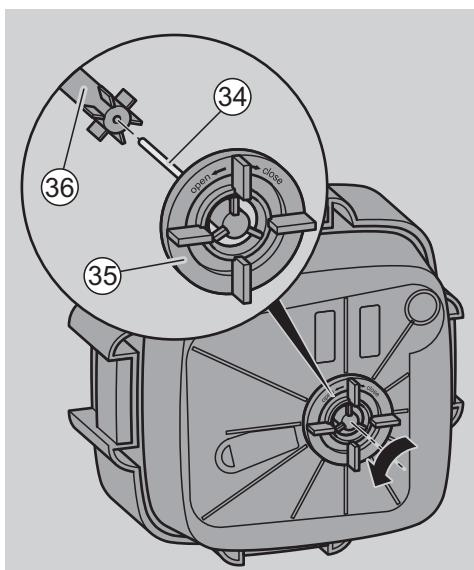
De waaier bevindt zich aan de onderzijde van de filterkop. De waaier bestaat uit een waaier (36) en een waaierschacht (34).
