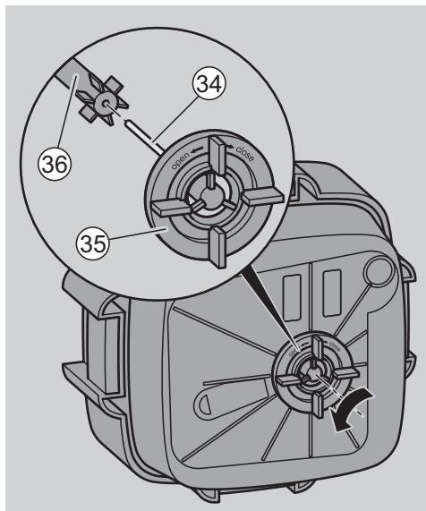
O rotor encontra-se na parte inferior da cabeça do filtro. O rotor é composto pela roda de palhetas (36) e pelo eixo do rotor (34).
