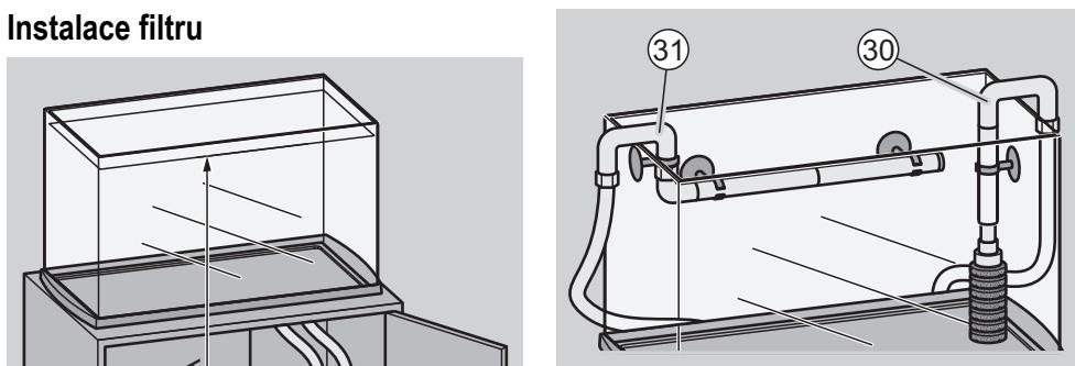
➤ Podle obrázku upevněte sací trubici (30) svisle na vnitřní stěnu akvária.
