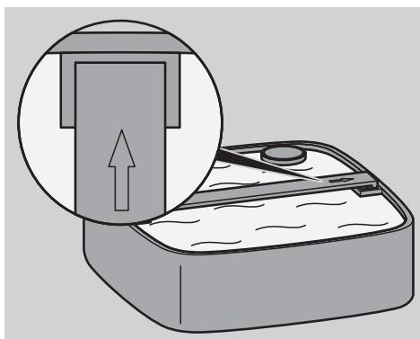
Na górnjej krawędzi obudowy filtru, na siatce przykrywającej i na koszach filtra znajdują się strzałki wskazujące ich prawidłowe ułożenie.
