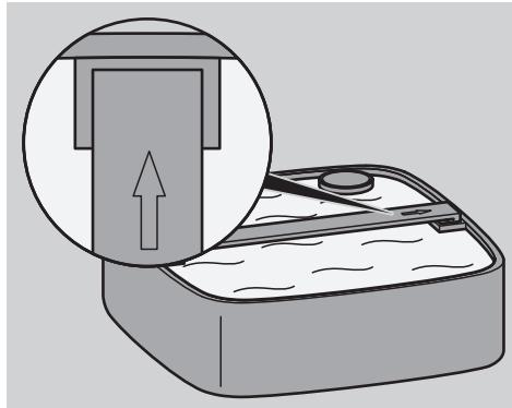
An der Oberkante des Filterbehälters, am Abdeckgitter und an den Filterköpfen befinden sich Pfeile zur korrekten Ausrichtung.
