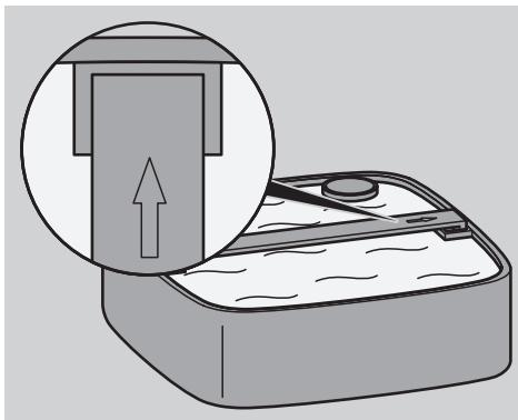
Na horním okraji filtrační nádoby, krycí mřížce a filtračních koších jsou šipky označující správné umístění.
