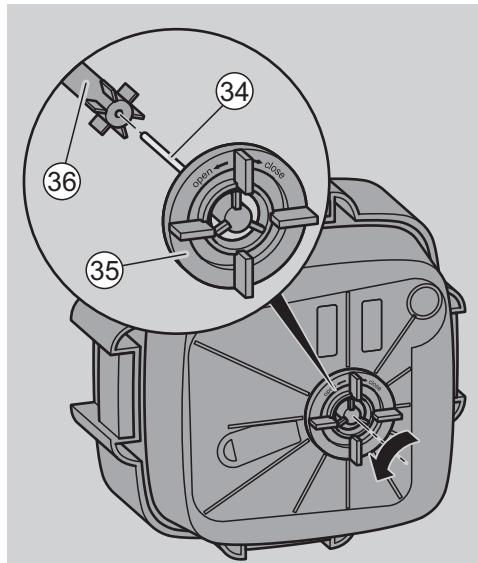
Impellern är monterad på undersidan av filterhuvudet. Denna består av ett fläktihjul (36) och en impelleraxel (34).
