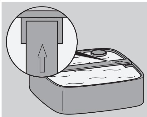
På overkanten af filterbeholderen, på afdækningsgitteret og på filterkurvene er der pile til at vise den korrekte placering.
