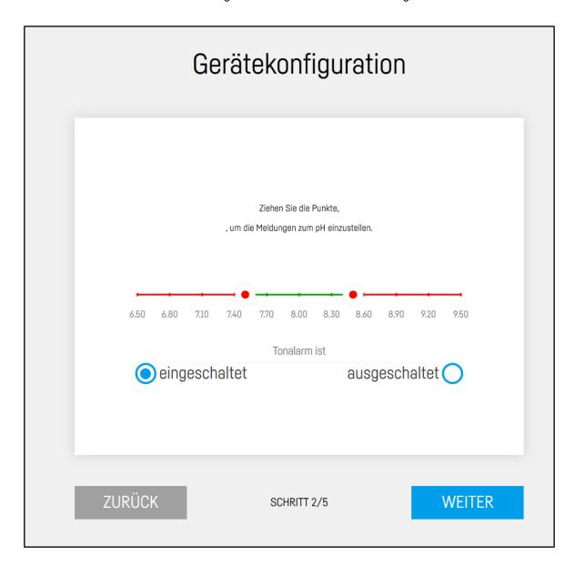
Die Standardgrenzen sind 7,5 und 8,5. Sie können auch einstellen, dass der akustische Alarm ausgelöst wird, wenn der Maximal- oder Minimalwert überschritten wird.
